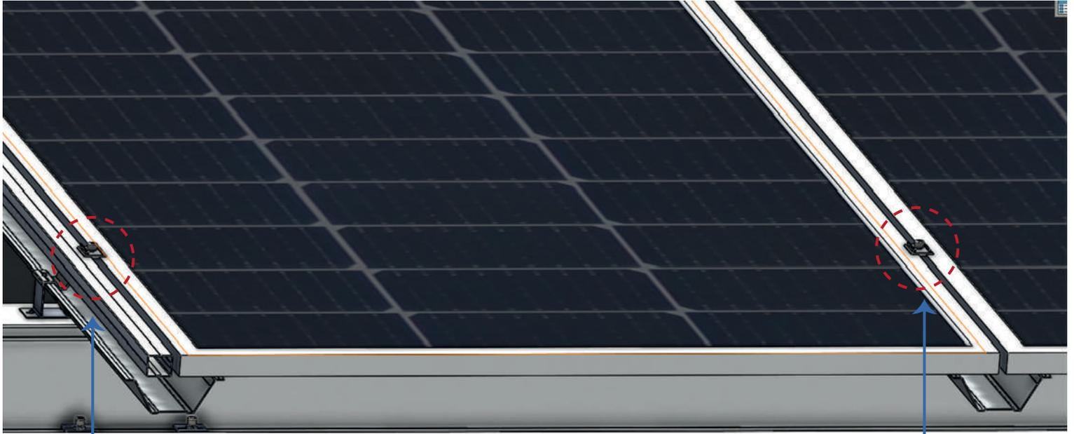
“Clamp Q-172” con “tubo terminal Q-171” en los costados del arreglo.
